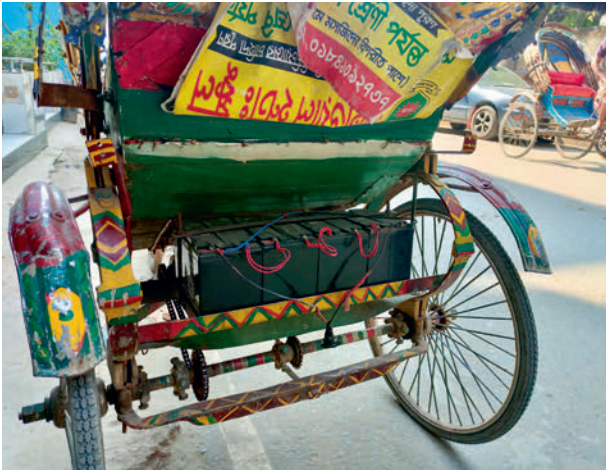
1 Zur E-Rikscha umgerüstete Fahrradrikscha, Dhaka
