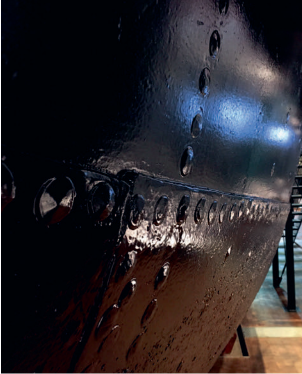
4 Die für die Nietbauweise typische Überlappung der einzelnen Rumpflplatten ist gut zu erkennen.
