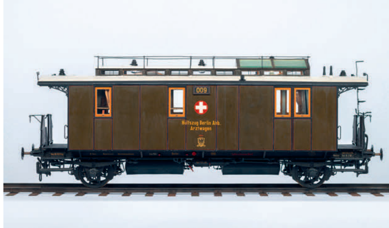
3 Das 1:5 Modell des Arztwagens „Berlin 009“ des Hilfszugs Berlin Anhalter Bahnhof entstand 1906 in der Hauptwerkstatt Tempelhof. Das Vorbild des Modells entstand vier Jahre früher ebenfalls in Tempelhof durch Umbau eines älteren Durchgangswagens 4. Klasse.
